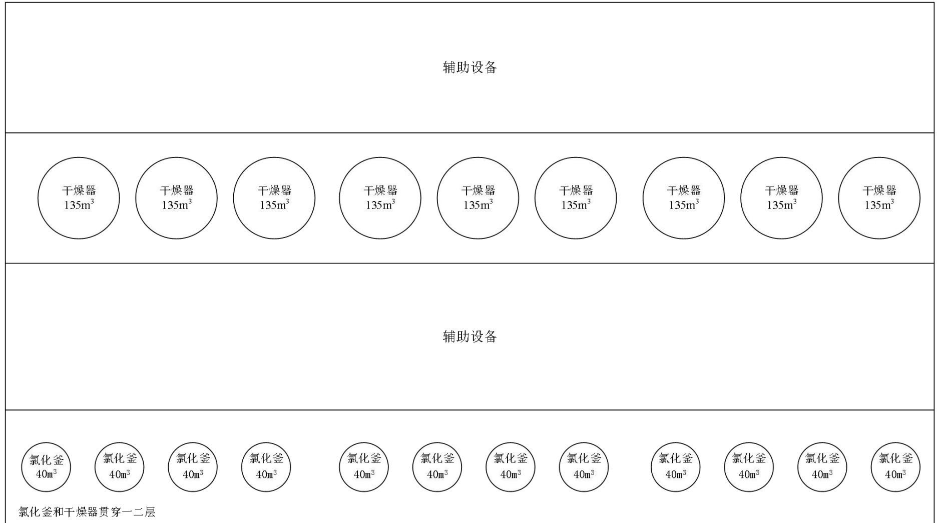
图 2.5-3 拟建项目主要设备平面布局图（二层）
