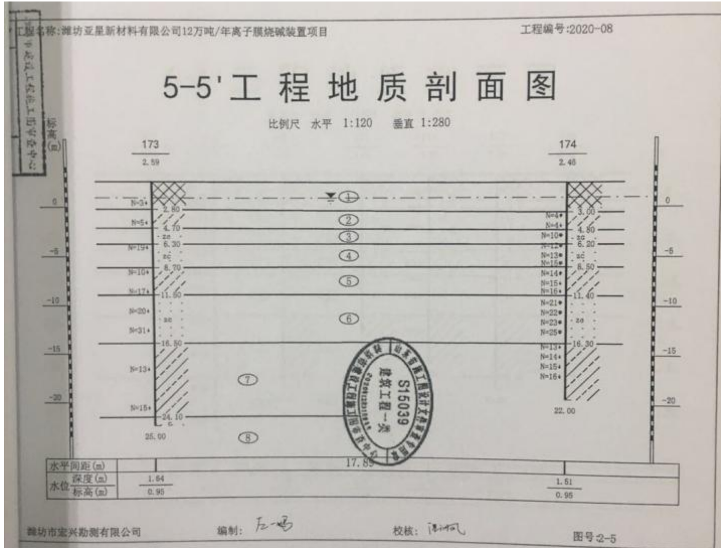
图 4.4-6 拟建项目所在地场区典型地层剖面图
